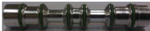
圖 9：全新閥軸加工實體圖
