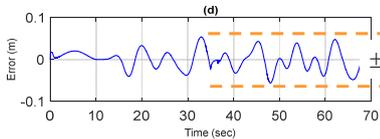
(d) Control error of 2<sup>nd</sup> hydraulic cylinder position control response
