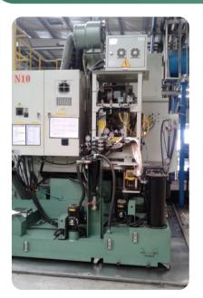
**挑戰**: 重件夾持需高壓穩定輸出及長時間保壓,傳統液壓站耗電高、產熱大。
