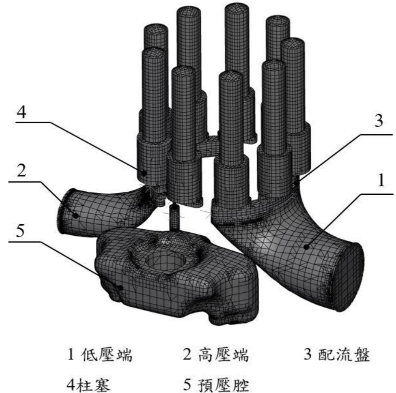
圖4.4 斜盤式柱塞泵空化模型網格化 35
