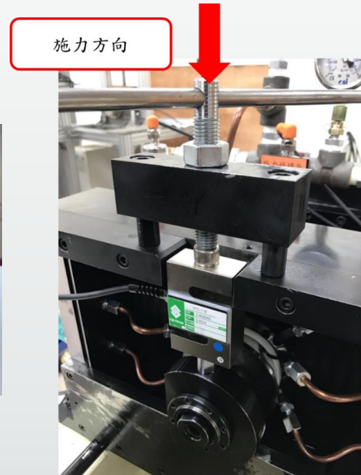
徑向螺桿施力於 徑向荷重元實體圖
