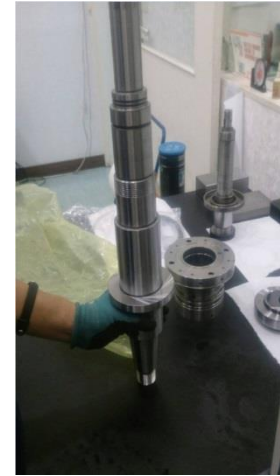
以耳部為基準量測b點段差
