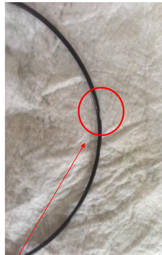
O型環因殼體孔位毛邊未修乾淨形成的破損
