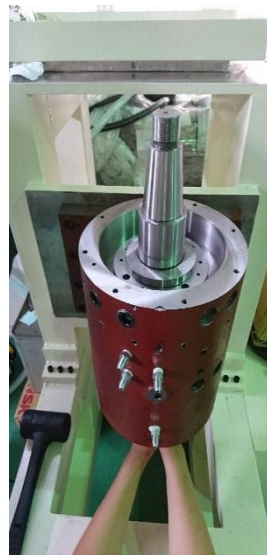
心軸、殼體套進主軸頭
