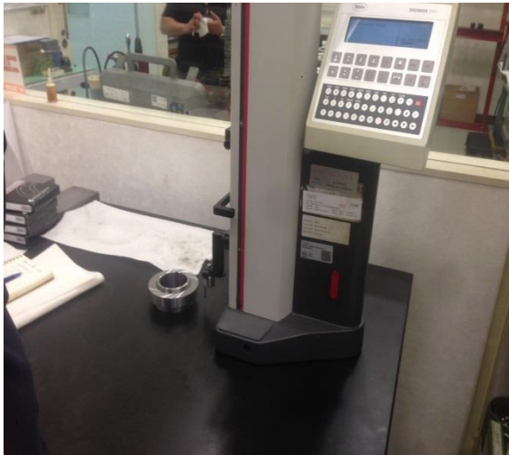
以線性高度歸量測尺寸
