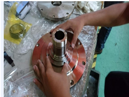
後法蘭與軸承內環壓蓋裝配測試
