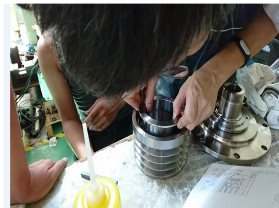
皮帶輪與軸承外環裝配測試
