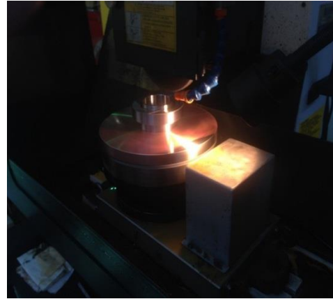
將止推間隙環放上磨床
