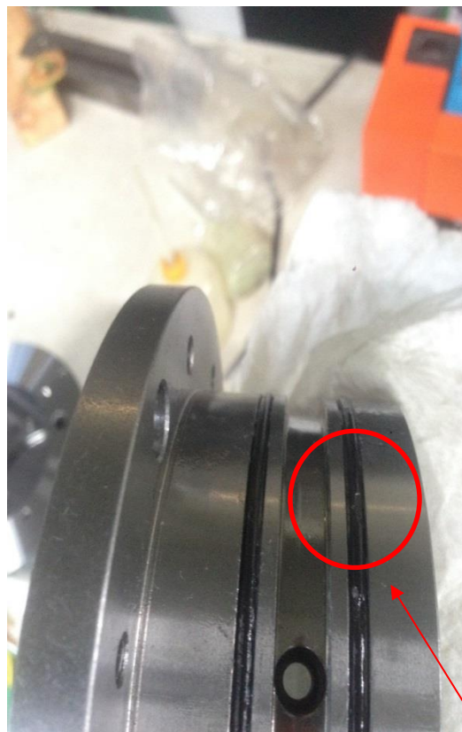
O型環因殼體孔位毛邊未修乾淨形成的破損
