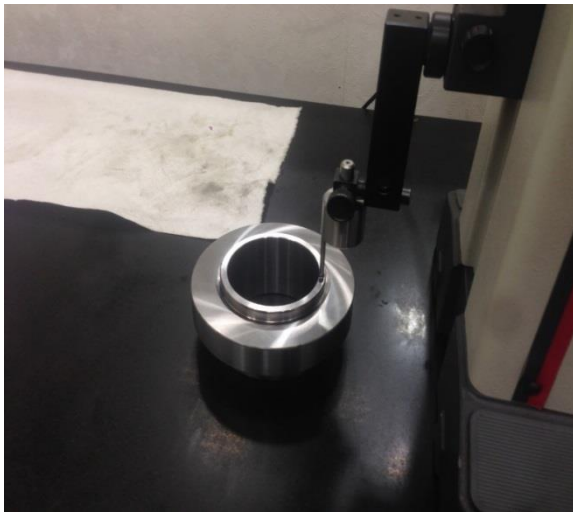
量測止推間隙環環段差
