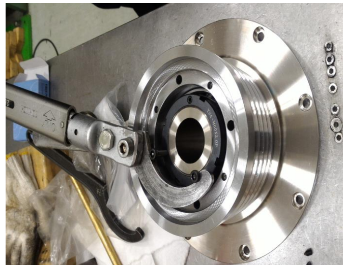
止付螺栓塗螺絲膠，鎖上30kg-cm扭力
