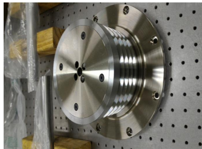
套上間隔環、彈簧鋼片、上蓋板、鎖上等高螺栓
