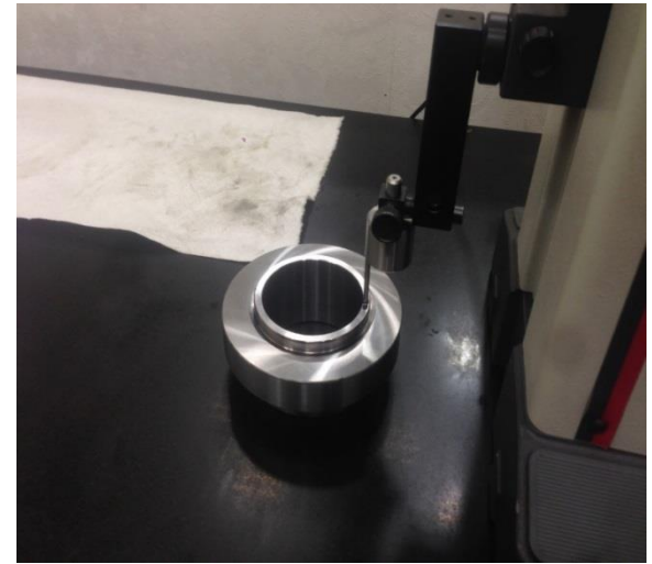
量測止推間隙環環段差
