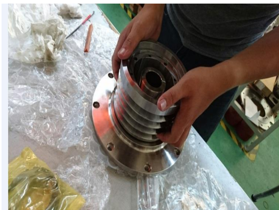
後法蘭與皮帶輪裝配測試
