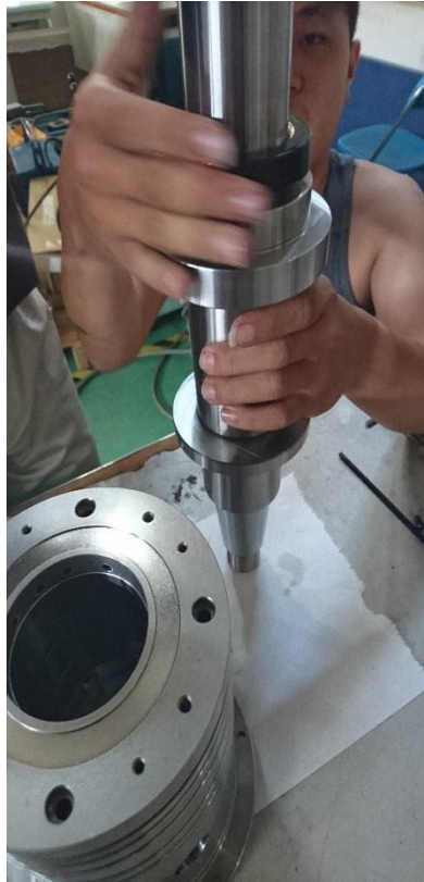
確認螺帽與止推間隙環是否能接觸鎖緊
