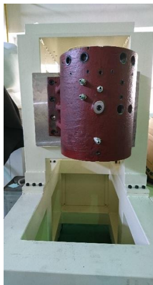
主軸頭放上測試架
